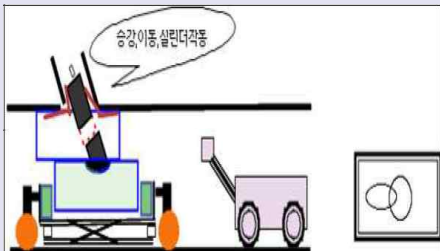
<비정립형 연결관 시공>
